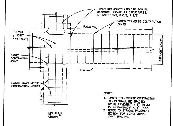
SPACING DIAGRAM FOR TRANSVERSE JOINTS
